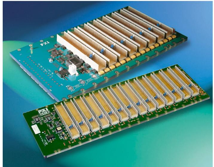
3U, 8 Slot & 14 slot PXI Backplane
